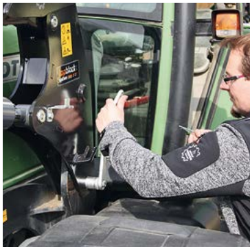
Bei dem „topblock“-System der kleineren Modellreihe muss man auf jeder Seite einen Exzenterbolzen ziehen...
